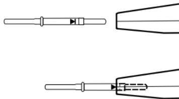
5. Un protège-pointe recouvre l'extrémité de certaines électrodes. Si un protège-pointe est présent, le retirer avant l'emploi.
