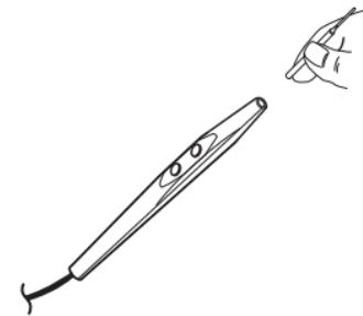
3. Asegúrese de que el manguito de aislamiento se inserta firmemente en la boca del lápiz de manera que ésta solape el manguito al menos 0,3 cm.
