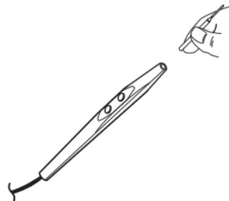
3. S'assurer que la gaine isolante s'adapte solidement à l'avant du crayon de façon à ce que l'avant chevauche la gaine isolante sur au moins 1/8 pouces (0,3 cm).
