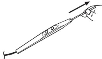
3. Kontrollera att isoleringshylsan sitter ordentligt fast inne i handtagets nos så att nosen överlappar isoleringshylsan med minst 0,3 cm.
