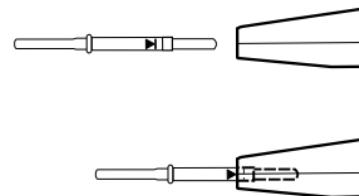
5. Ett spetsskydd täcker änden på vissa elektroder. Om ett spetsskydd sitter på ska det avlägsnas före användning.
